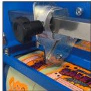
Bahn-Trenner mit bis zu sechs Messern bestückbar.
