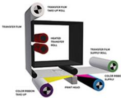
Herkömmliche Direct-to-Card-Drucker verwenden einen Druckkopf, der über ein Farbband direkt auf die Karte druckt. Retransferdrucker drucken auf eine flexible, transparente Folie, die dann mit der Karte thermisch verbunden wird, was ein strapazierfähigeres, kratzerunempfindliches Produkt ermöglicht. Diese Retransfertechnologie produziert Bilder in optimaler Qualität mit lebendigeren und satteren Farben – sogar auf unebenen Kartenoberflächen, wie z. B. Schlüsselanhänger-Karten oder Smartcards.
